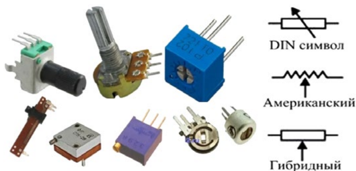
Рис. 10. Переменные резисторы (потенциометры)
